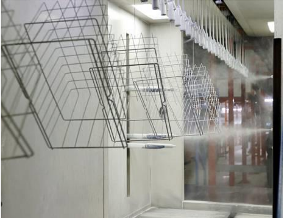
Lankakorit kiertävät ruiskumaalauslinjalla. KUVA: KARI MANKONEN
